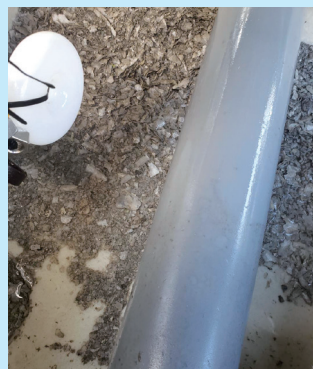
剥がれ落ちて底に堆積した スケールの山
