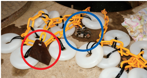
▲ACRはチェーンにインシュロックで結び付けるだけ。誰でも簡単に設置ができます。赤丸は赤サビ化した鉄の破片（テストピース）です。ACRの効果で赤サビが黒サビ化しているかを、このテストピースで確認します。青丸のロックナットは重りです。
