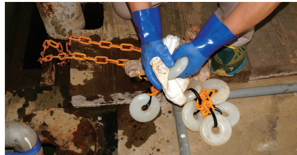
▲定期的にACRを引き上げて、本体についた汚れをウェスで拭き取ります。
